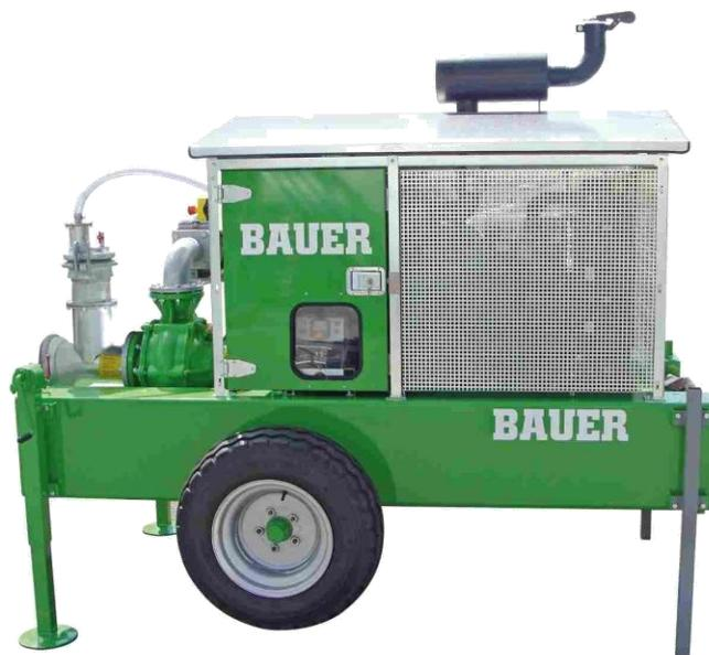
**Дизельный насосный агрегат**
